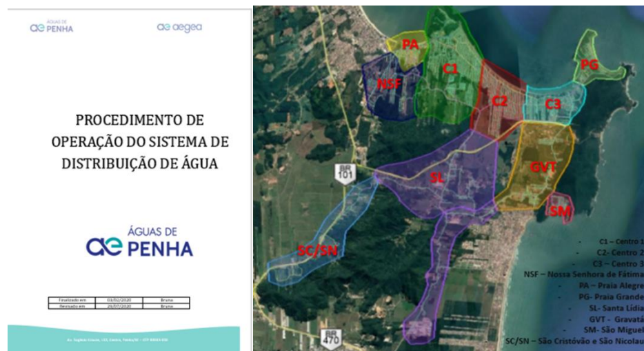
Figuras 21 e 22: Procedimento de operação do sistema de distribuição de água e setores de abastecimento da cidade de Penha.
