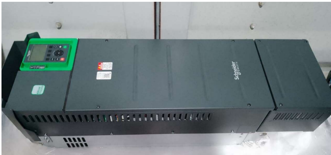
Figura 17 - Inversor de frequência
